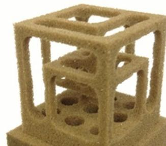
五軸工作機械で加工
