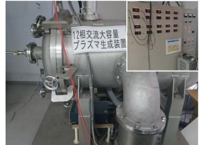
12相交流プラズマ生成装置（定格2kV,12kVA）
